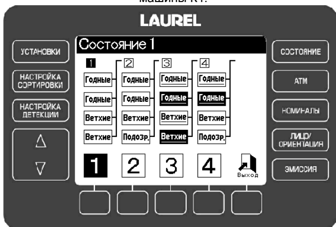
Схема для 4-х карманной счетно-сортировальной машины K4:
