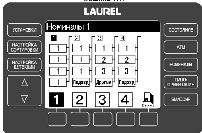
Схема для 4-х карманной счетно-сортировальной машины K4:
