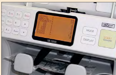
В SB-1050 запрограммировано пять режимов отображения данных на экране: «по количеству и итоговой сумме», «по количеству» (общий и детальный обзор), «по номиналу» (детальный обзор) и «причина отбраковки»
