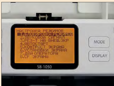
В настройках меню предусмотрена регулировка уровня чувствительности УФ-, МГ-, ИК-датчиков, настройка режимов работы, скорости счета
